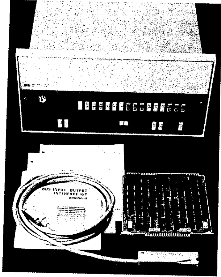
Şekil 3.17: Hewlett-Packard 21MX Tipi minibilgisayar ve onun arabirim ünitesi
