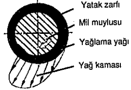
Şekil 3 : Yağ kamasında basınç dağılımı
