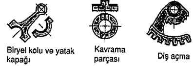
Şekil 3: Dıştan broşlanmış profiller
