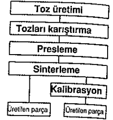
Şekil 2 : Sinterlenmiş bir iş parçasının üretim kademeleri
