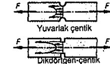
Şekil 3: Bir çekme çubuğunda gerilme
