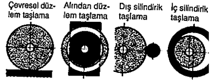
Şekil 1: Taşlama metoduna bağlı olarak temas yüzeyleri
