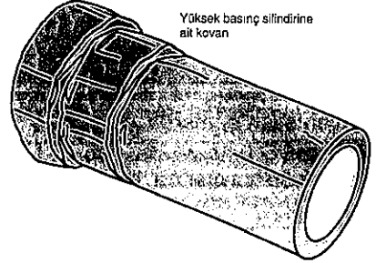
Şekil 2: Serbest şekillendirme suretiyle imal edilen iş parçası
