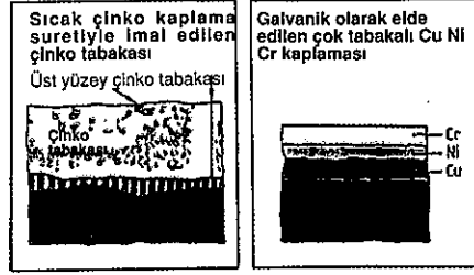
Şekil 1 : Metallik kaplamanın yapısı
