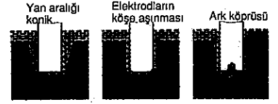
Hata oluşumunun temel sebepleri Yüksek Impuls akımı, Uzun Impuls süresi, Kısa Impuls aralığı, yetersiz çalkalama
