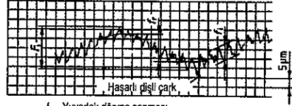
f_r Yuvarlak dönme sapması f_i Yuvarlanma izi (bir diş bölümünde) F_t Yuvarlanma sapması (Toplam sapma)
