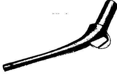
Şekil 1: Ti Al 6 V 4'ten yapılmış olan kalça mafsali implantatı
