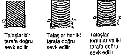
Şekil 2 : Yiv açılan ve freze edilen dişler
