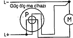
Şekil 2 : Doğrudan elektrik gücü ölçme
