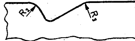
Şekil 3.14 Bükme yarı çapları, simetrik olmayan V kalıbı
