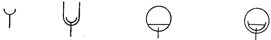
Kılıflı ve kılıfsız gösterilmiş foto-elektrik katot
