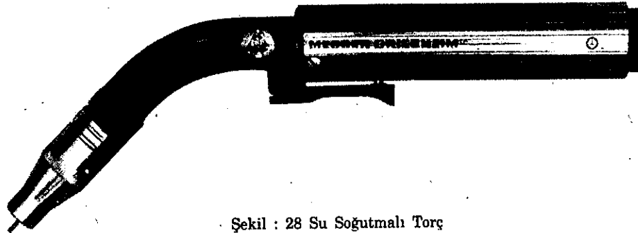
Şekil : 28 Su Soğutmalı Torç
