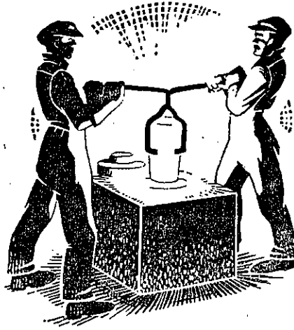
Şekil 4.16 Atelye tabanındaki bir ocaktan potanın çıkarılması
