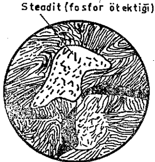
Şekil 8.6 Esmer dökme demir yapısında Steadit
