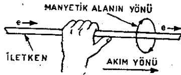
Şekil 9-8. Akım geçen bir iletkenin etrafında meydana gelen manyetik alan için sol el kaidesi.
