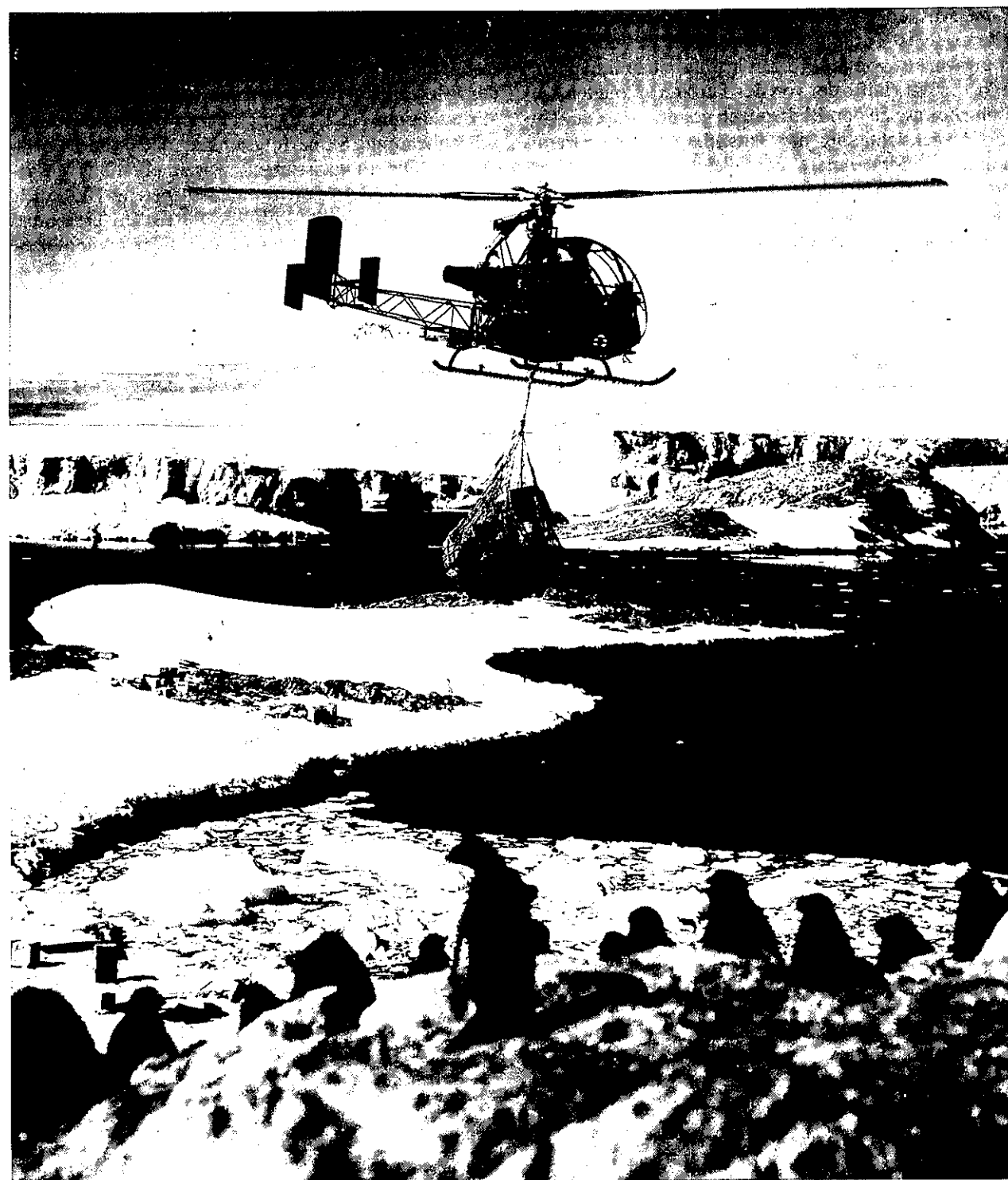
Die »Djinn« war der erste in Serie gebaute Hubschrauber mit Blattspitzenantrieb.
