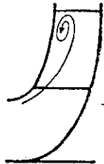
(Şekil: 73) Santrifüj çarkta kaynaşma.
