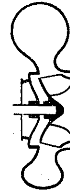
(Şekil: 81) Kapalı rotorlu heliko-santri- füj tulumbanın difüzörü.
