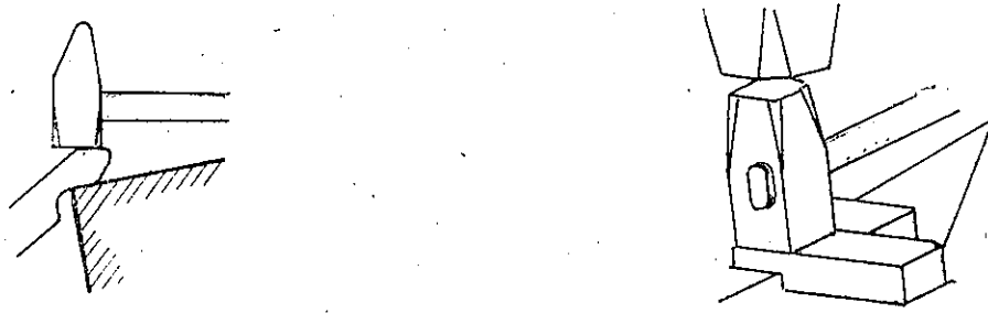
Şekil: 112 Tek yönlü boğmada keskin kenarın giderilmesi
