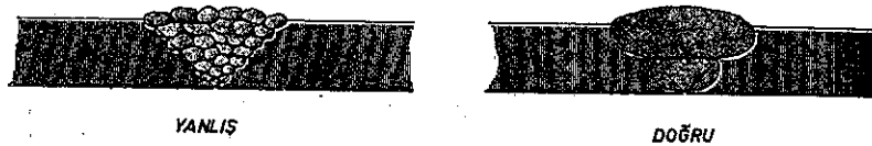
Şekil:7-31 Az sayıda dikiş çekilerek deformasyon önlenir.
