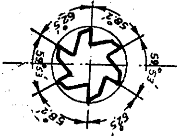
Şekil 74 — 6 dişli bir raybada diş taksimatı.
