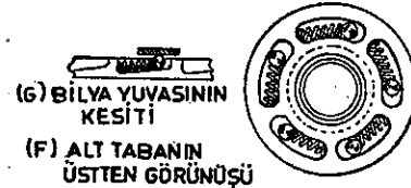
Şekil 6-9. (Rotokep) döndürme tertibatı kontrollü ve doğru döme sağlar.
