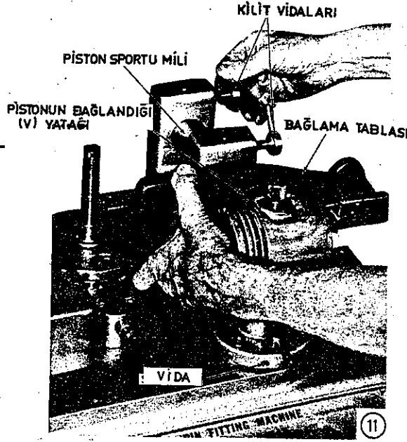
Şekil 9-124. Pistonun (V) yataklı tablaya bağlanması.
