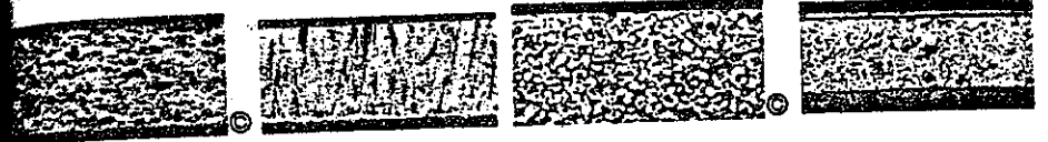
Şekil 8-8. Çelik üzerine tutturulmuş çeşirli bakır alaşımı yataklarının mikrofotosu. Büyütme takriben 100x1 dir.
