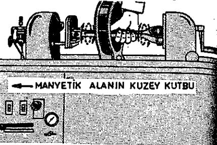
EKSENE DİK OLAN ÇATLAKLAR GÖRÜNÜR
