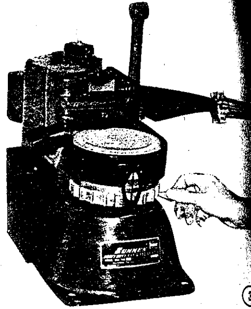
Şekil 9-58. Tablayı taşın üzerinden çektikten sonra talaş miktarını ayar ediniz.
