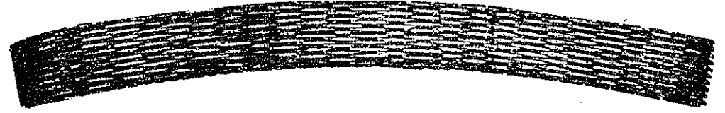
Şekil 3-44. Aşınmış bir eksantrik zinciryanlamasına bu şekilde bükülebilir.
