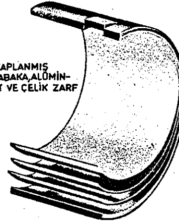
Şekil 8-11. Bu çok katlı alüminyum alaşımı yatak çok ağır hizmetler içindir.
