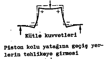
Gaz basıncı Krank ana yatak yerlerine geçiş kısımlarının tehlikeye sokulması
