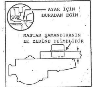
Şekil:6-205 Rochester 2GC karbüratörde şamandıra seviyesinin ölçülmesi.
