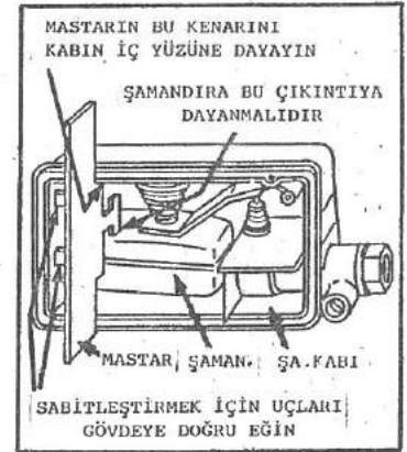
Şekil:6-211 Dört boğazlı Holley karbüratöründe seviye ayarı.
